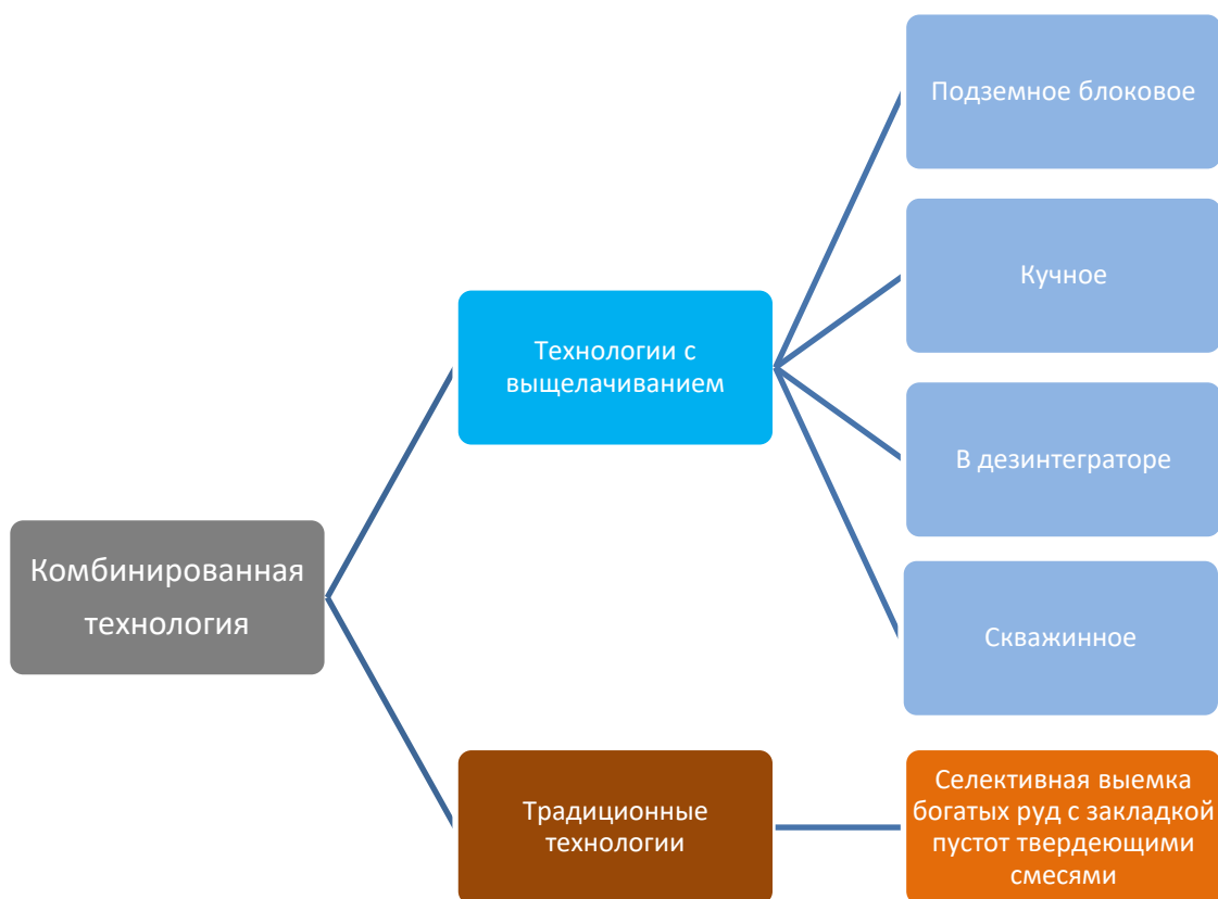
Рисунок 2.9 — Комбинирование традиционных технологий и технологий с выщелачиванием металлов
