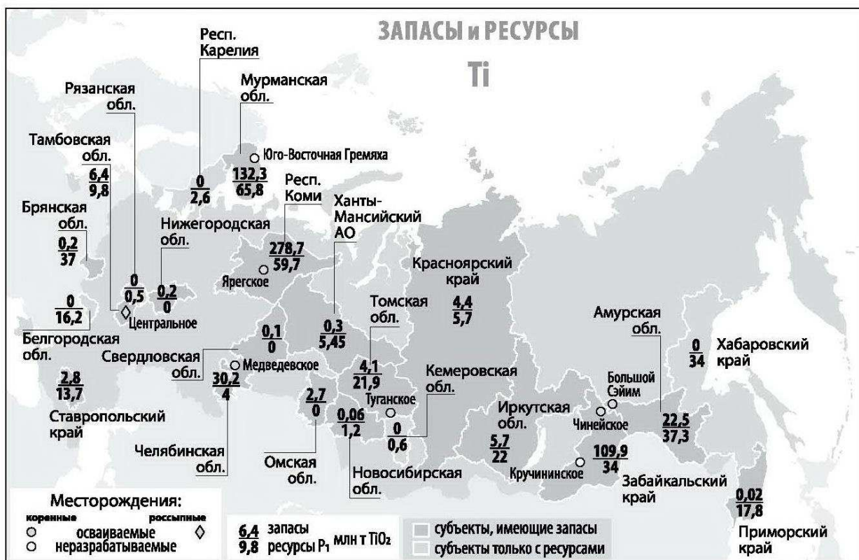
Рисунок 1.18 — Основные месторождения титана и распределение запасов и прогнозных ресурсов категории P 1 диоксида титана (млн т) по субъектам РФ [9]
